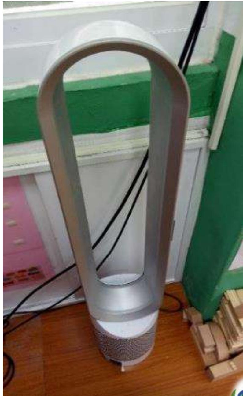
圖5-8 空氣淨化機放置角落或過於靠近物品而不利氣流循環與淨化(續)
