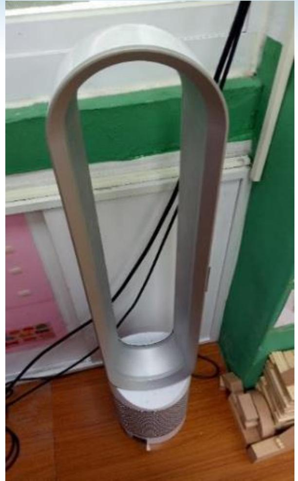
圖1-8 空氣淨化機放置角落或過於靠近物品而不利氣流循環與淨化(續)
